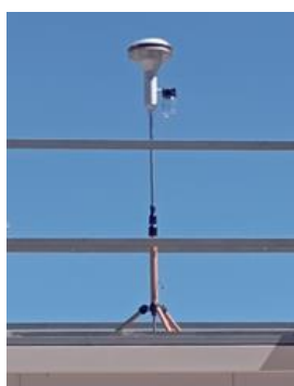
Figura 12: Cabezal de PM_{10} para toma de muestra de aire ambiente.
