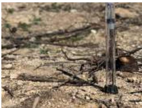
Fig. 4. Mini-disk infiltrometer.
