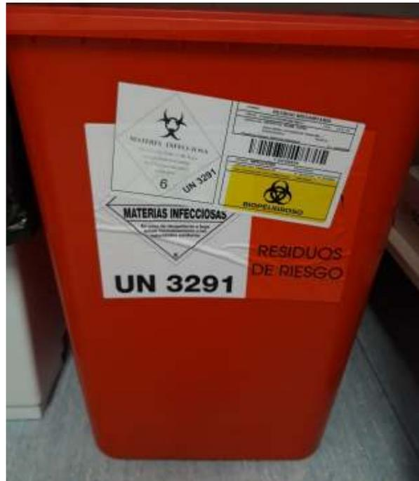
Figura 5. Contenedor para el transporte de residuos que van a ser incinerados o descontaminados fuera de la zona de trabajo.
