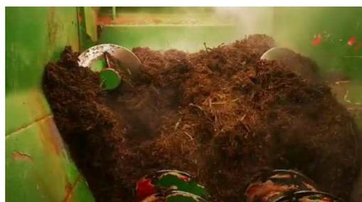
**Figura 3.6.** Detalle del proceso de volteo y mezclado de las pilas.
