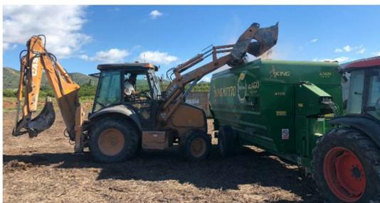
**Figura 3.5.** Maquinaria utilizada para el montaje y volteo de las pilas (retroexcavadora y mezcladora kingnT170).
