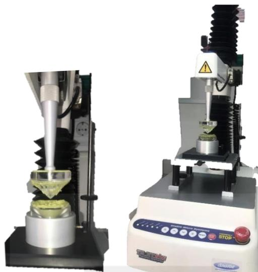
**Figura 18.** Texturómetro TA-XT2i.
