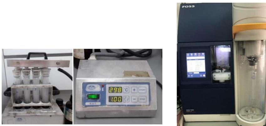
**Figura 12.** Digestor Büchi Digestion Unit modelo 426 (izquierda) y destilador Büchi Destillation Unit modelo B-316 (derecha).
