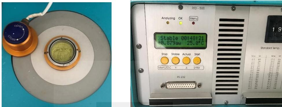
Figura 15. Higrómetro electrolítico Novasina modelo TH-500.
