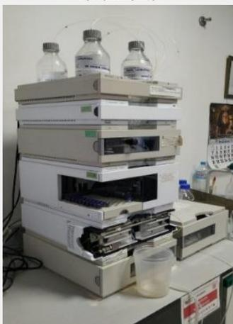
Imagen 3.5.7.2.2. Detalle del cromatógrafo de líquidos de alto rendimiento
