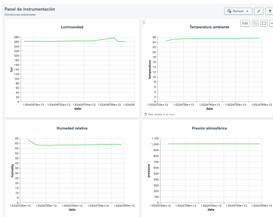
Figura 5.3: Captura de pantalla de un panel de instrumentación generado con las herramientas de MongoDB para mostrar los valores de las variables medidas con el dispositivo de adquisición de las condiciones de entorno durante la realización de una sesión de prueba.
