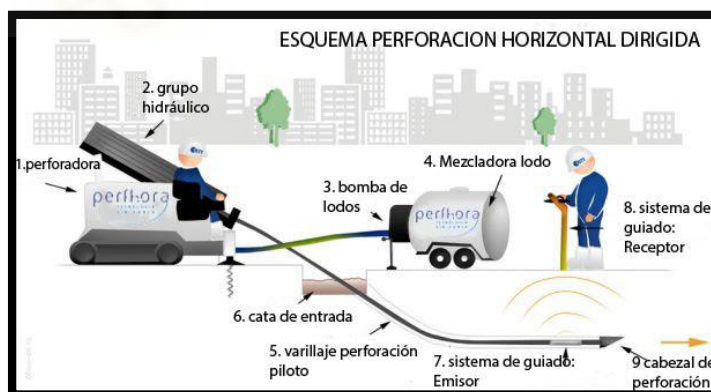
Ilustración 71. Esquema de una perforación horizontal dirigida (PHD).
