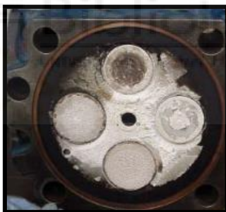
Ilustración 23. Formación de depósitos de sílice en motor de combustión.
