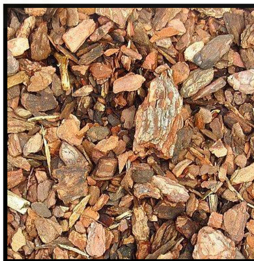
Ilustración 43. Corteza de pino utilizada en el sistema de biofiltración.
