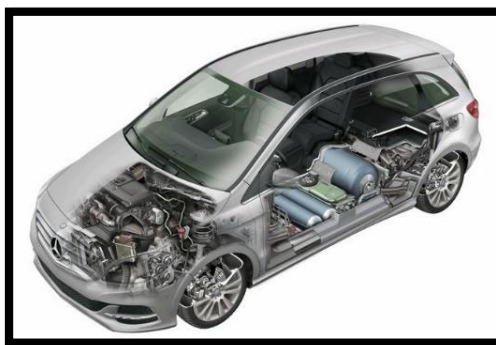
Ilustración 18. Imagen de las diferentes partes que se integran en un turismo alimentado por biometano.
