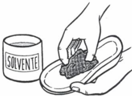
Figura 38. Limpieza de superficie mediante frotado con disolvente
