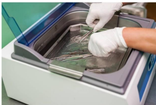
Figura 37. Limpieza superficial con baño de ultrasonidos
