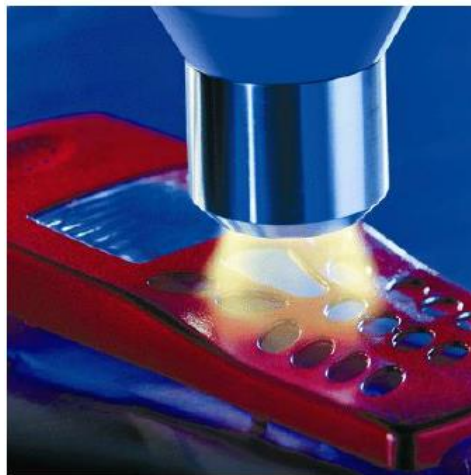
Figura 3. Aplicación chorro de plasma a presión atmosférica (APPJ)
