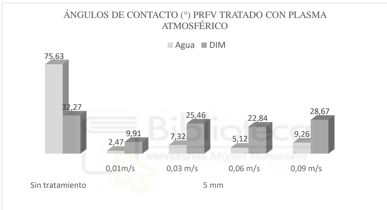
Figura 73. Gráfica comparativa de la variación del ángulo de contacto en la superficie del PRFV después del tratamiento de plasma atmosférico en función de la velocidad y para una distancia boquilla/sustrato de 5 mm y sin tratamiento
