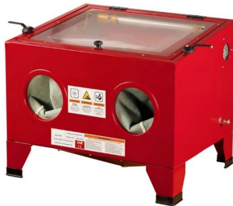
Figura 48. Máquina de chorreado de arena utilizada en este estudio
