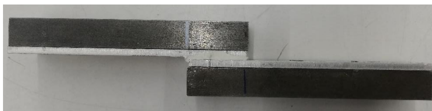
Figura 67. Pletinas de acero adheridas a los sustratos, en este caso de aluminio AW-5754
