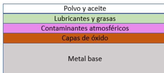
Figura 34. Posibles capas superficiales en un metal
