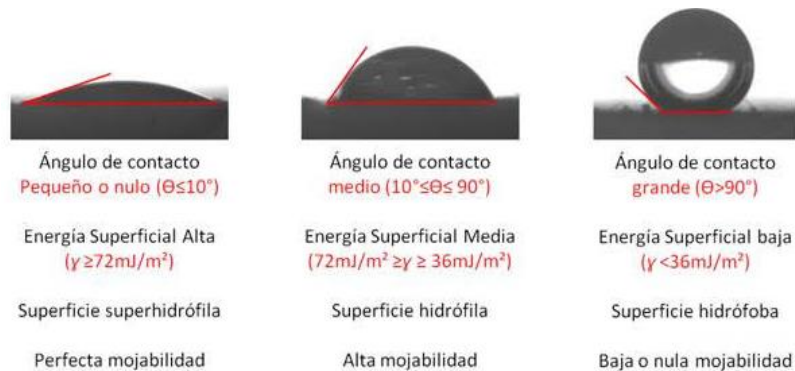
Figura 16. Teoría de la adsorción termodinámica o mojabilidad
