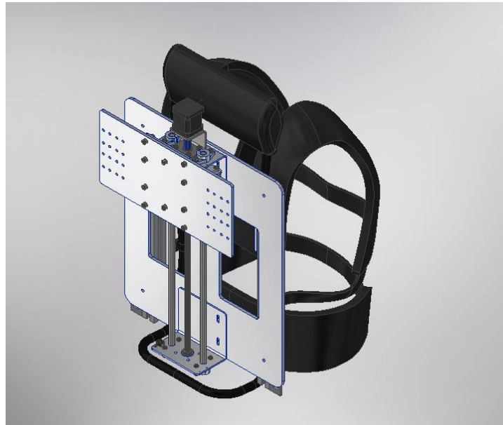
Figura 34: Conjunto completo sistema de elevación
