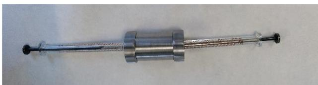
Figura 13. Extruder utilizado para la preparación de LUVs con filtros de policarbonato de 100 nm de poro.
