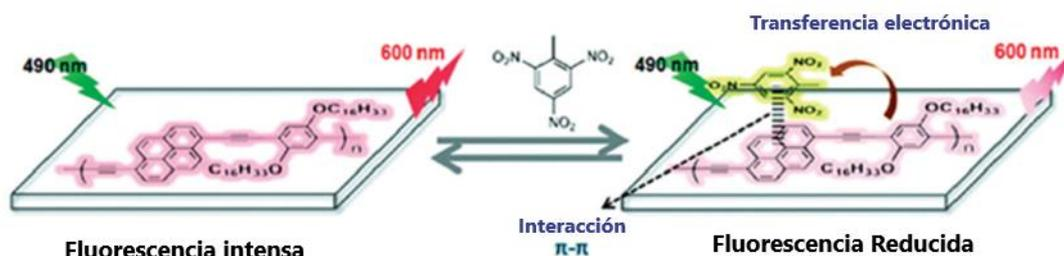
Figura 4. Esquema representativo de la transferencia de energía fotoinducida entre una molécula derivada de fluoreno y un compuesto nitroaromático (TNT). Imagen modificada de: (Sun et al., 2015)
