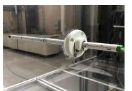
Figura A.07: Anemómetro de hilo caliente.
