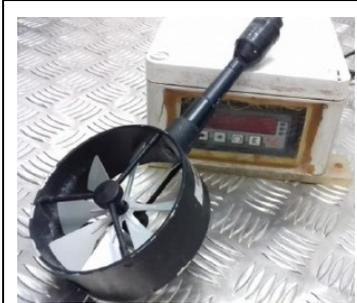
Figura A.06: Anemómetro de molinete
