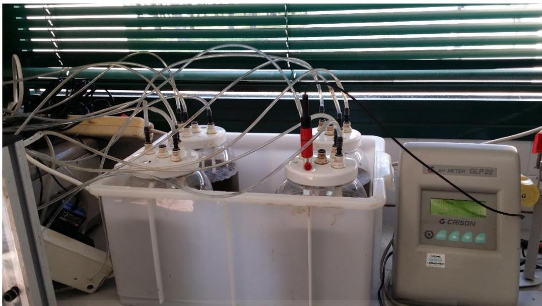
Figura 20: 4 frascos (tereftalato de polietileno) plásticos con volumen efectivo de 2 L cada uno y pHmetro.
