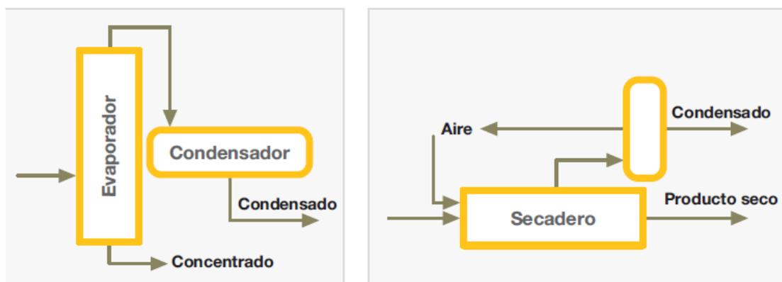
Figura 3: Evaporación al vaciado y secado. Fuente: [www.arc-cat.net](http://www.arc-cat.net)
