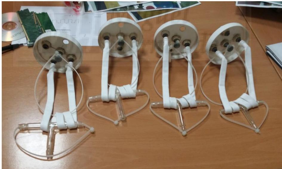
Figura 17: Membranas tubulares microporosas e hidrófobas, hechas con politetrafluoroetileno expandido (ePTFE) (Phillips Scientific Inc., Rock Hill, SC), usadas para capturar el  $NH_3$ . Fuente: propia.
