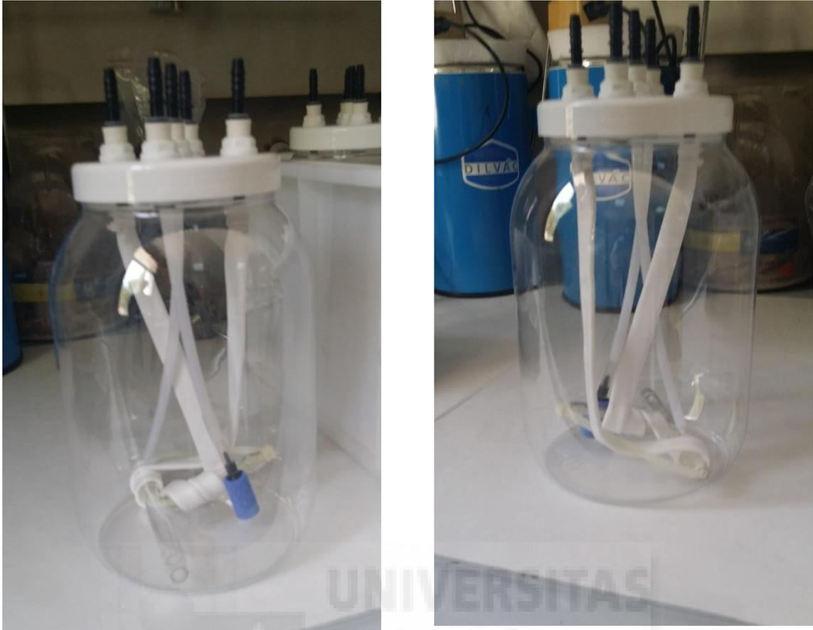
Figura 18: frascos (tereftalato de polietileno) plásticos con membrana de PTFE y aireador. Fuente: propia.
