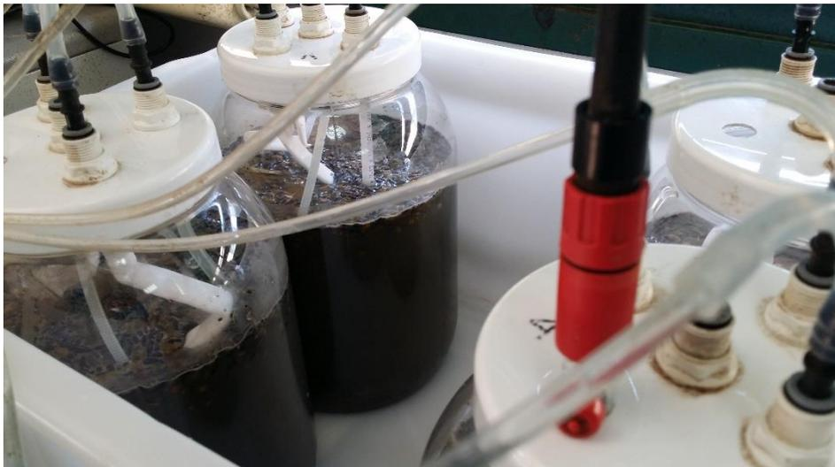
Figura 19: 4 frascos (tereftalato de polietileno) plásticos con volumen efectivo de 2 L cada uno y pHmetro. Fuente: propia.
