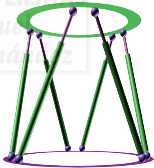
Fig. 1-4 Estructura de la plataforma de Gough.
