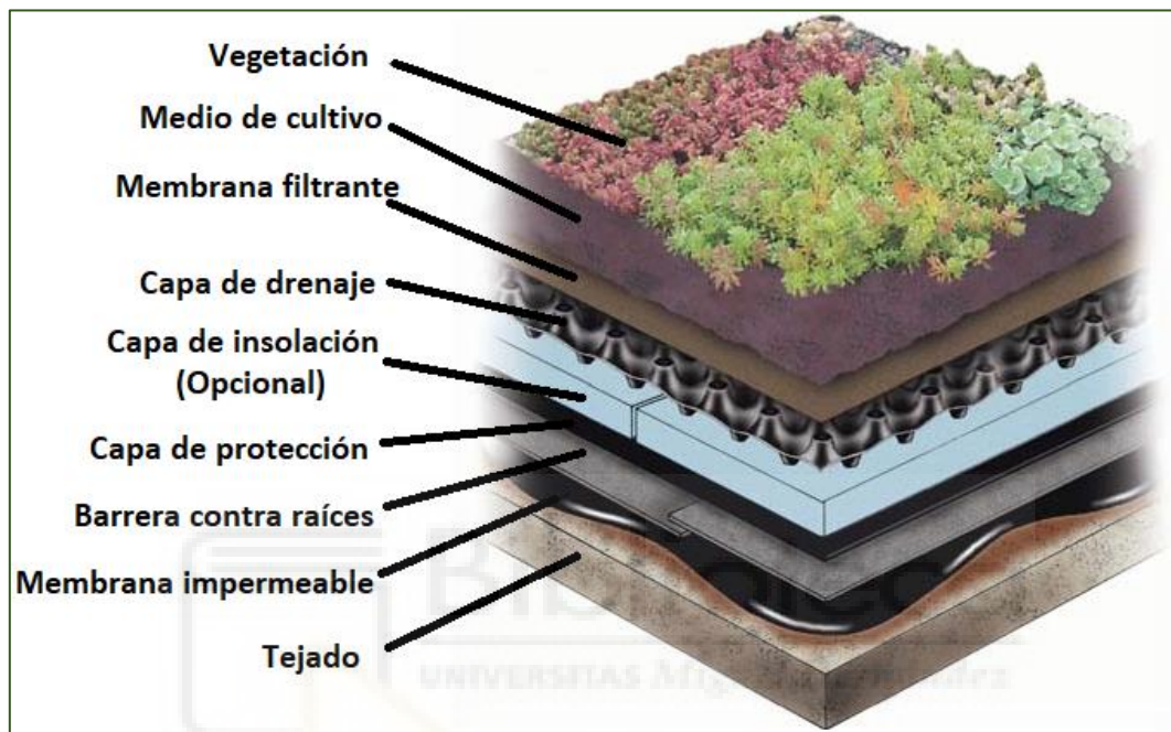
Figura 8. Capas típicas de un tejado verde. Fuente: Tolderlund (2010).
