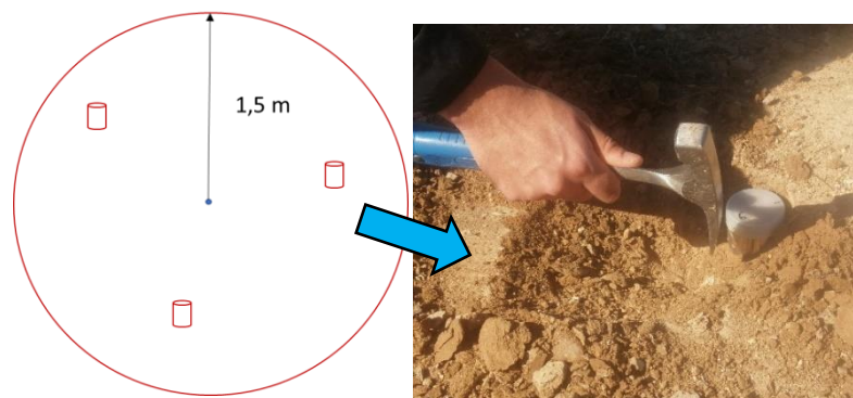
Figura 17: Zona de muestreo alrededor del punto, indicando posición a modo de ejemplo de los tres cilindros (sub-muestra) de suelo inalterado tomado.
