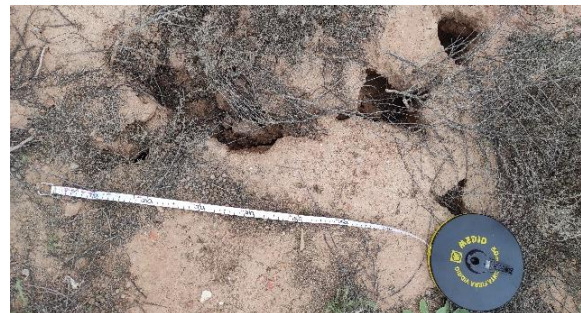
Figura 12: Pequeñas subsidencias y pipelines generadas por la erosión hídrica en la zona de estudio. Fuente: Elaboración propia.
