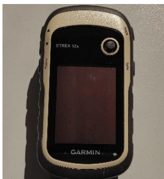
Figura 16: GPS Garmin ETRX 32x, usado para geolocalizar los puntos de muestreo. Fuente: Elaboración propia.
