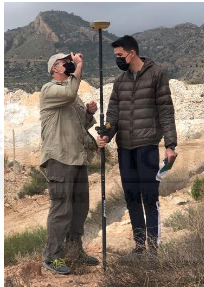
Figura 21: GPS diferencial HiPer SR de la compañía Topcon usado en la zona de estudio. Fuente: Levantina, 2021.
