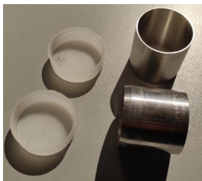
Figura 19: Cilindro metálico usado para la extracción de muestras de suelo. Fuente: Elaboración propia.
