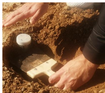
Figura 20: Extracción de muestras de suelo mediante el método del cilindro metálico. Fuente: Navarro, 2021.
