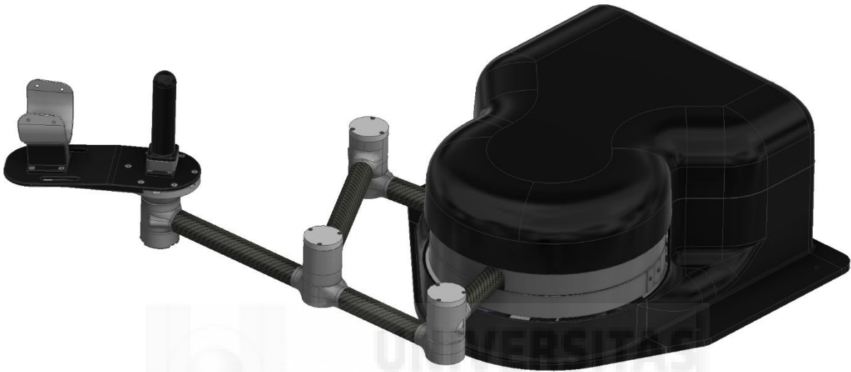
Imagen 2. Modelo 3D del dispositivo robótico Rubidium para la rehabilitación de miembro superior.
