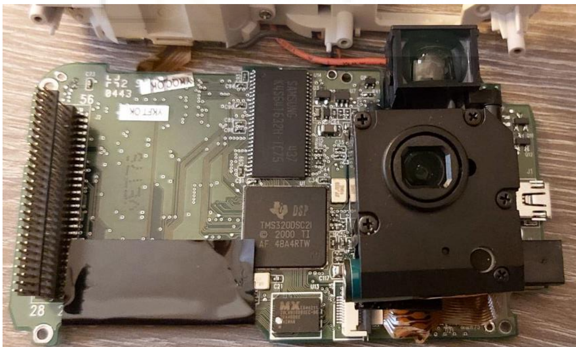
Figura 3: Procesador de imagen TMS320DSC21 en Olympus D-395 .
