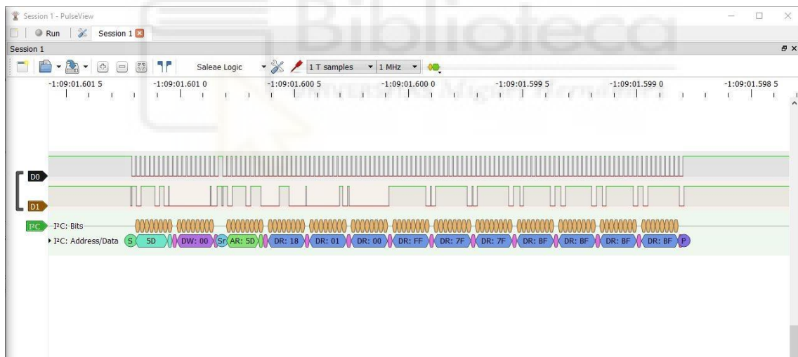
Figura 23: Lectura de varios registros visto en el analizador lógico.
