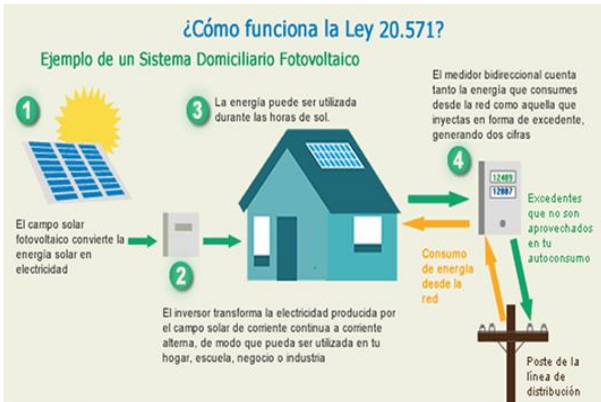
Figura 4. Funcionamiento sistema domiciliario fotovoltaico
