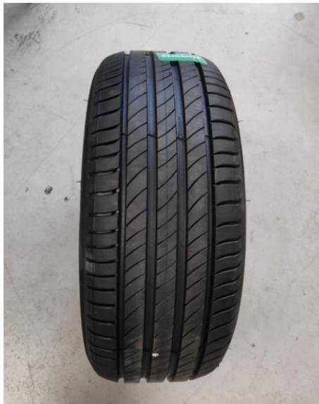
Figura 23: Neumático Michelin Primacy 4 205/55 R16 91V empleado en los ensayos.
