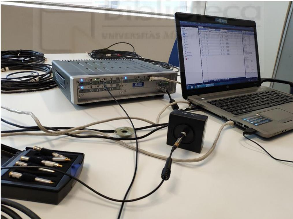
*Figura 24: Calibración de los micrófonos*
