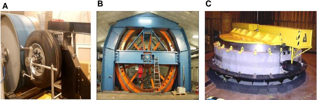
Figura 12: Diferentes configuraciones Drum. De derecha a izquierda: A) Banco de ensayos tipo Drum de la Technical University of Gdansk, Polonia. B) Instalación tipo Drum del Federal Highway Research Institute (BASt), Alemania. C) Máquina de ensayo tipo Drum denominada Tire Pavement Apparatus Test en Purdue University, Estados Unidos.
