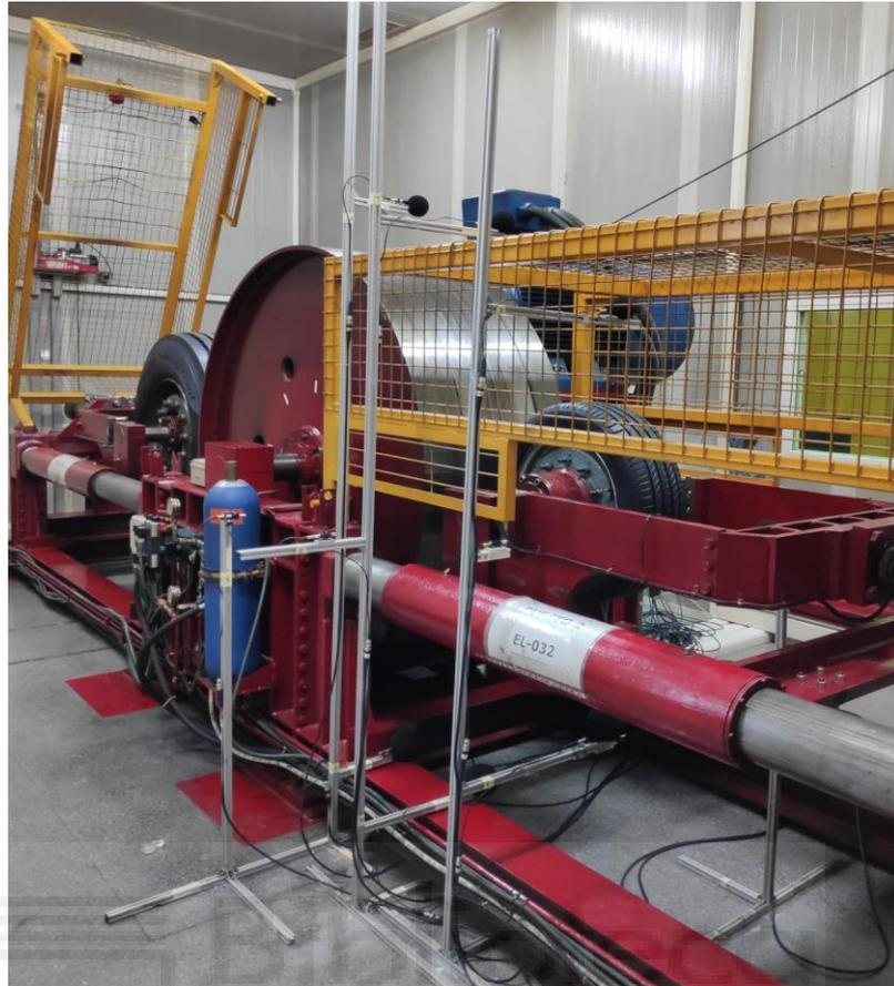
Figura 32: montaje micrófonos sobre banco de ensayo con rejilla de protección.
