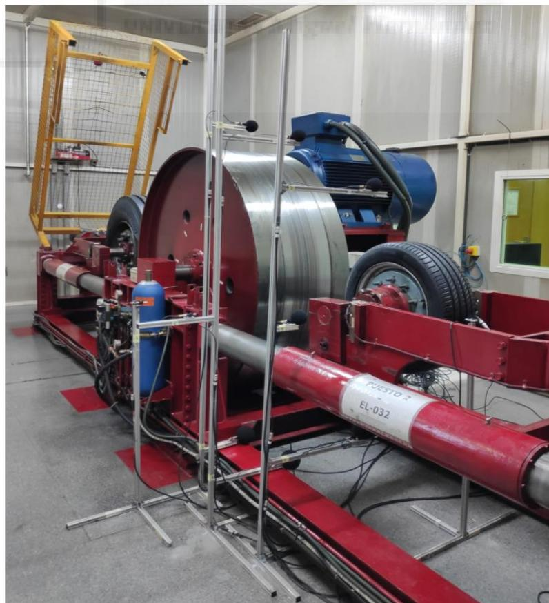
Figura 31: Montaje micrófonos sobre banco de ensayo.
