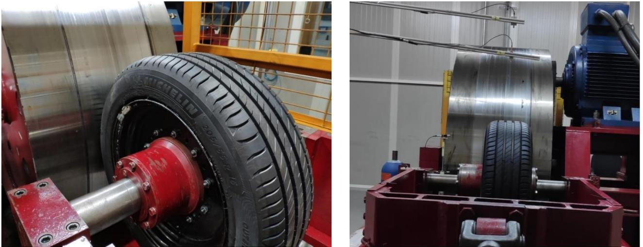
Figura 29: Neumático desplazado del eje tras montaje.
