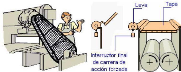
Imagen 23. Resguardos fijos y móviles en elementos de transmisión
