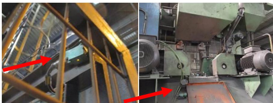
Imagen 31. Puerta frontal y tapa del tromel sin módulo de seguridad
