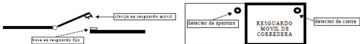
Imagen 34. Enclavamiento clavija-base y con detectores de proximidad
