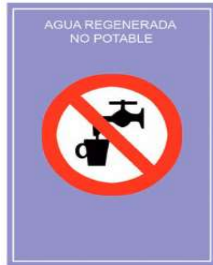
Figura 16: Panel de señalización en zonas de acceso al agua regenerada. Fuente: Guía aplicación 1620/2007.
