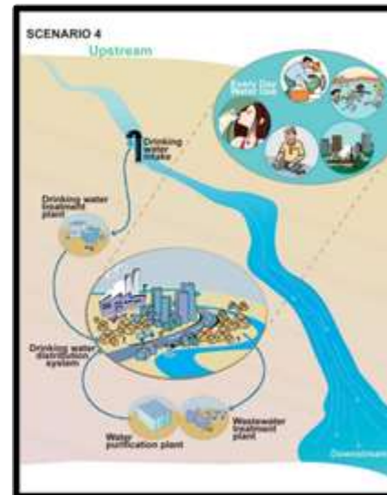
Figura 2: modelo de reutilización de agua directa o planificada. Fuente: HidroJing.com
