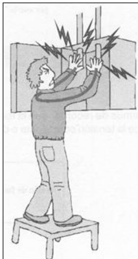
Fig. 4: Trayectoria corriente entre dos fases pasando por el corazón.
