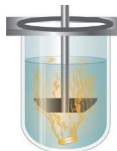
Figura 9. Envase del aparato 2 de disolución [24].
