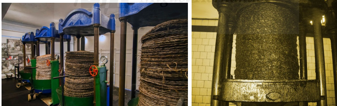
Figura 1.10. Sistema de extracción de prensa hidráulica. Fuente:
