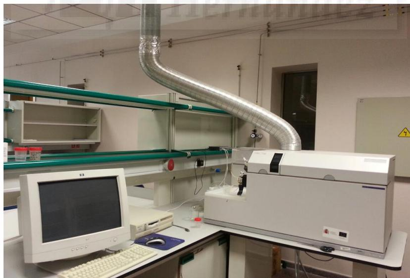
**Figura 6.** Equipo ICP-MS utilizado en este estudio.
