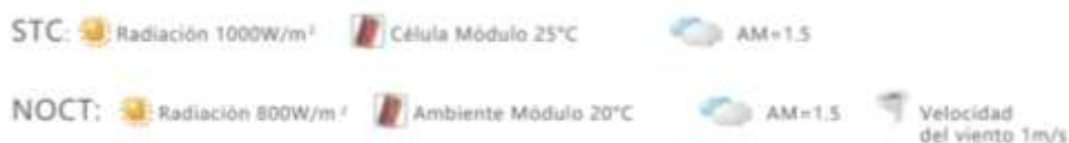
▪ Imagen 11: Condiciones sobre las que se hacen las medidas de los módulos FV
