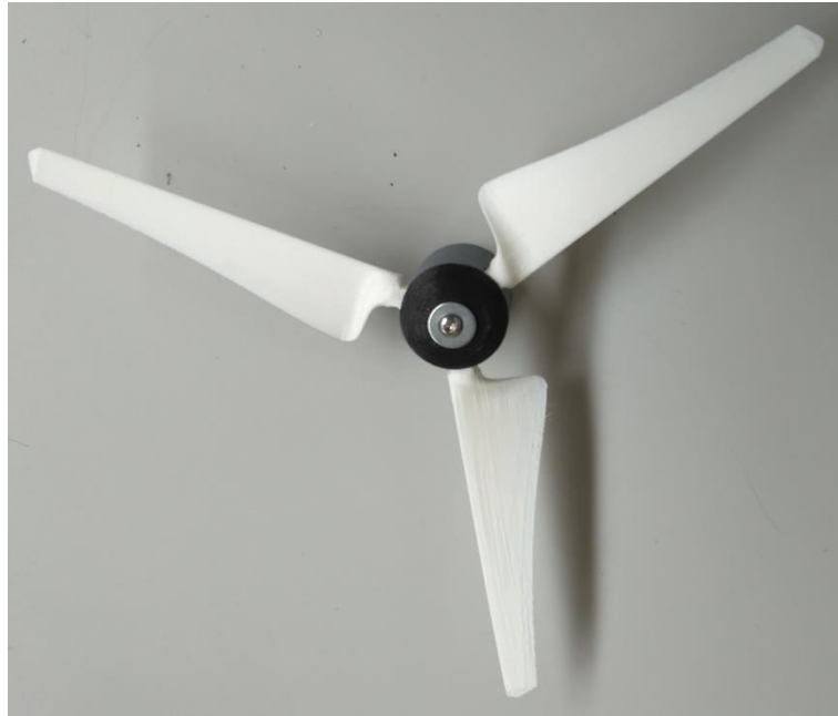
Figura 37: Rotor diseñado para 4000 rpm impreso.
