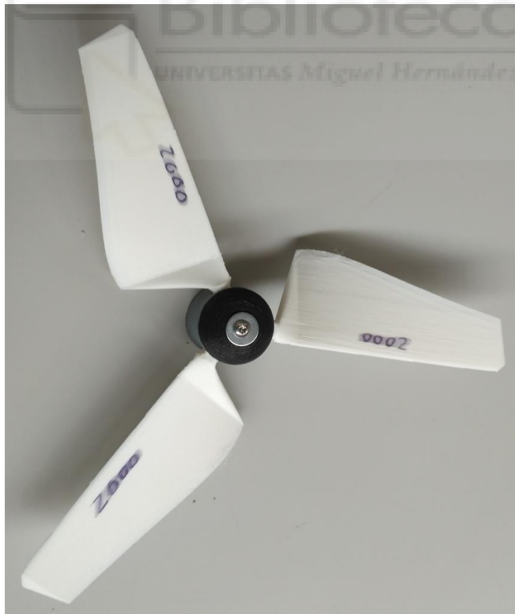
Figura 34: Rotor diseñado para 2000 rpm impreso.
