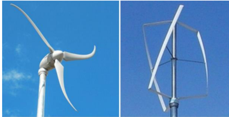
Figura 7: Izquierda: eje horizontal. Derecha: eje vertical.
