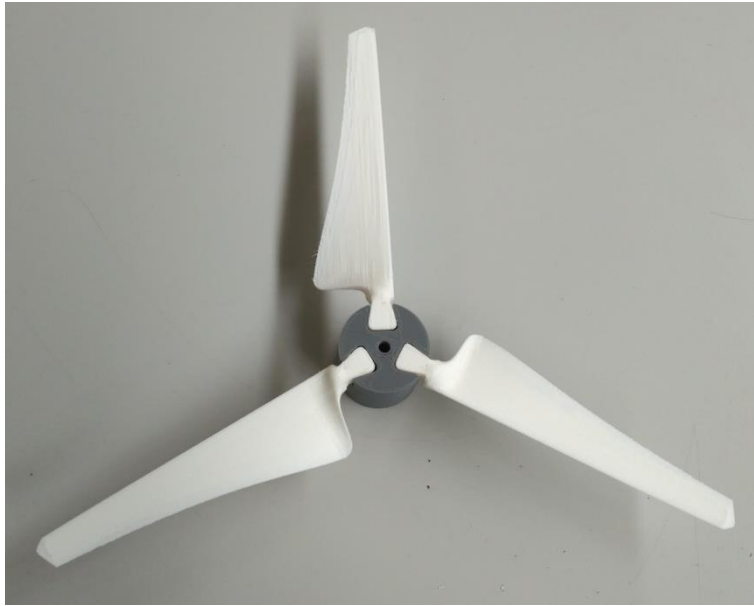
Figura 35: Rotor diseñado para 3000 I rpm impreso.
