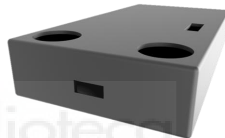
Figura 13: Concepto de caja de plástico protectora. Diseño propio realizado en Inventor
