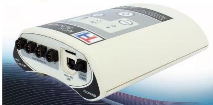
*Figura 9: Dispositivo Tech-Hub al que van conectadas las IMU's [28]*
