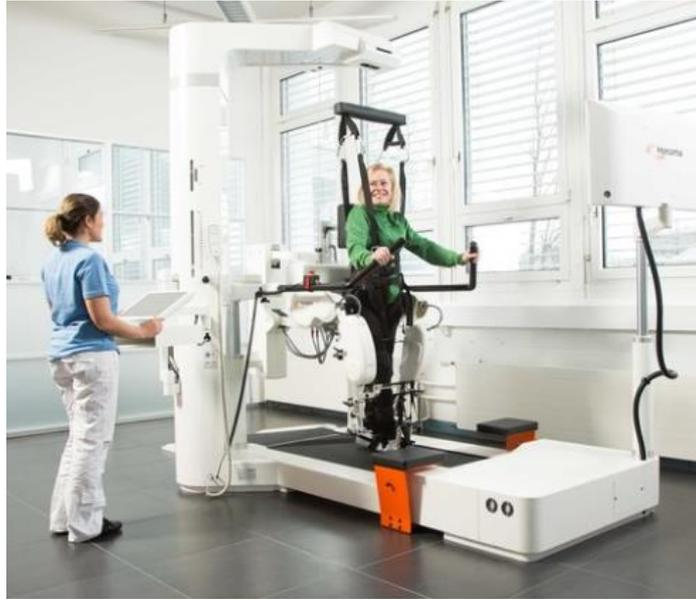
*Figura 7: Exoesqueleto de apoyo para rehabilitación de la marcha Lokomat [27]*
