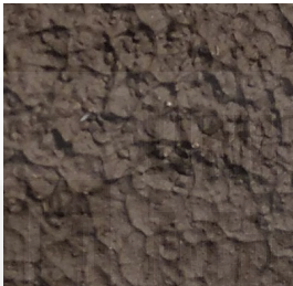
Fig. 46 Arcilla Negra PM Manganeso, Sio2 + Chamota aplicada con pincel
