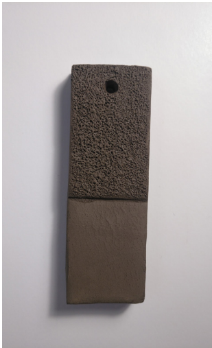
Fig. 45 Arcilla Negra PM Manganeso, Sio2 + Salfuman aplicado con pincel
