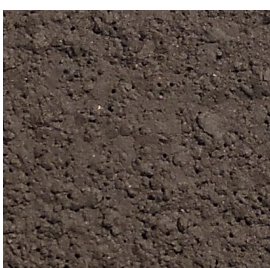
Fig. 47 Arcilla Negra PM Manganeso, Sio2 + Vinagre aplicado con pincel
