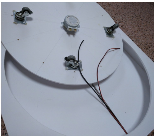
Fig. 55 Con todo sellado, se pasan los cables por un canal generado en el cartón pluma para que las ruedas no sean un obstáculo.
