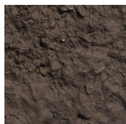
Fig. 50 Arcilla Negra PM Manganeso, SiO 2 + Chamota y barbotina aplicada con pincel
