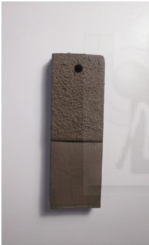
Fig. 46 Arcilla Negra PM Manganeso, Sio2 + Chamota aplicada con pincel
