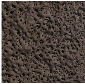
Fig. 45 Arcilla Negra PM Manganeso, Sio2 + Salfuman aplicado con pincel
