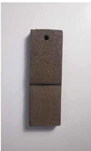
Fig. 47 Arcilla Negra PM Manganeso, Sio2 + Vinagre aplicado con pincel
