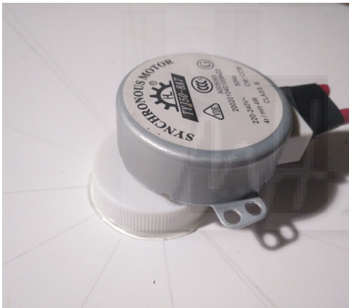
Fig. 53 A continuación, colocamos el motor síncrono con silicona caliente.
