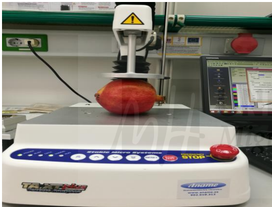
Fotografía 14. Texturómetro para medir la firmeza de las granadas
