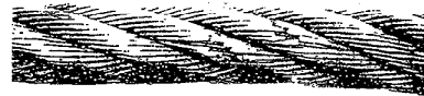
Cliché 5 - Numerosas roturas de alambres a la altura de la polea de compensación (y a veces oculta por ésta). El cable debe ser retirado.
