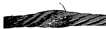
Cliché 18 - Aplastamiento por acción mecánica que da lugar a un laminado del cable. El cable debe ser retirado.
