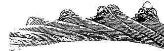
Cliché 12 - Agravación del defecto anterior en un grado que justifica la retirada inmediata del cable.
