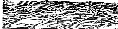
Cliché 2 - Fuerte desgaste y numerosas roturas de alambres (trenzado cruzado). El cable debe ser retirado inmediatamente.
