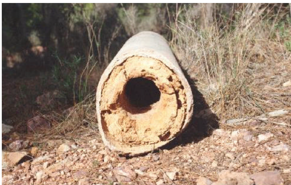
Figura 3.2.1.1. Disminución del diámetro efectivo de una tubería
