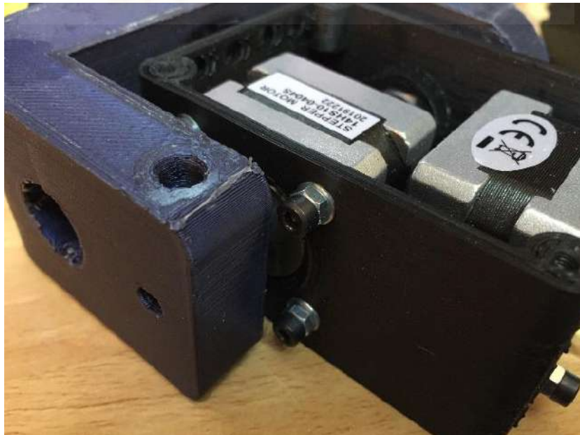
Figura 102 - Montaje del motor de la articulación q5
