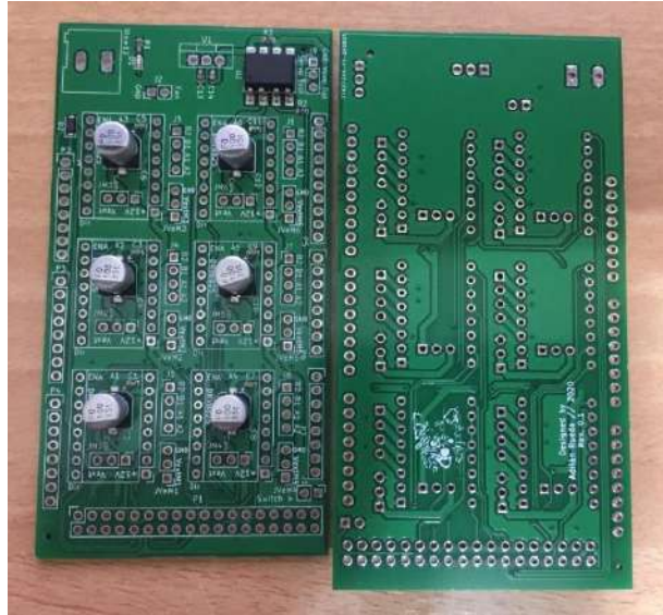
Figura 42 - Caras frontal (izquierda) y trasera (derecha) de la PCB
