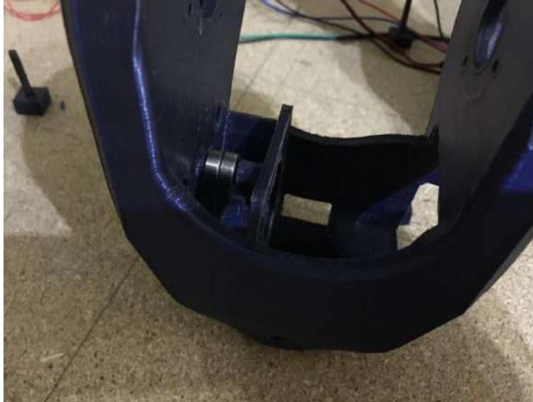
Figura 85 - Montaje de rodamientos 623ZZ del codo
