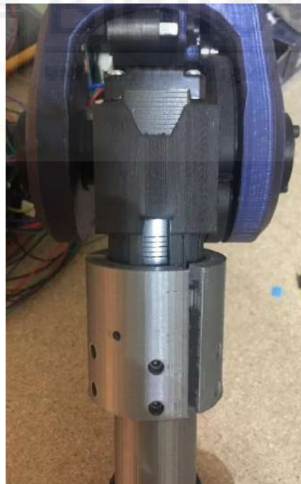
Figura 27 - Diseño implementado del antebrazo en el robot
