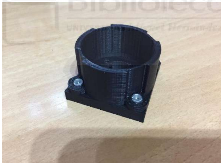
Figura 76 - Soporte del motor con reductora
