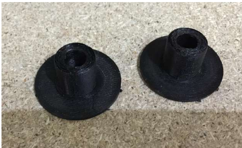
Figura 84 - Preparación de los casquillos y arandelas de ajuste del codo
