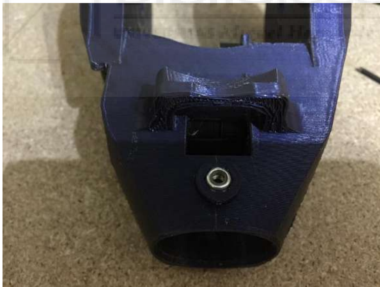
Figura 86 - Inserción de la tuerca autoblocante del codo
