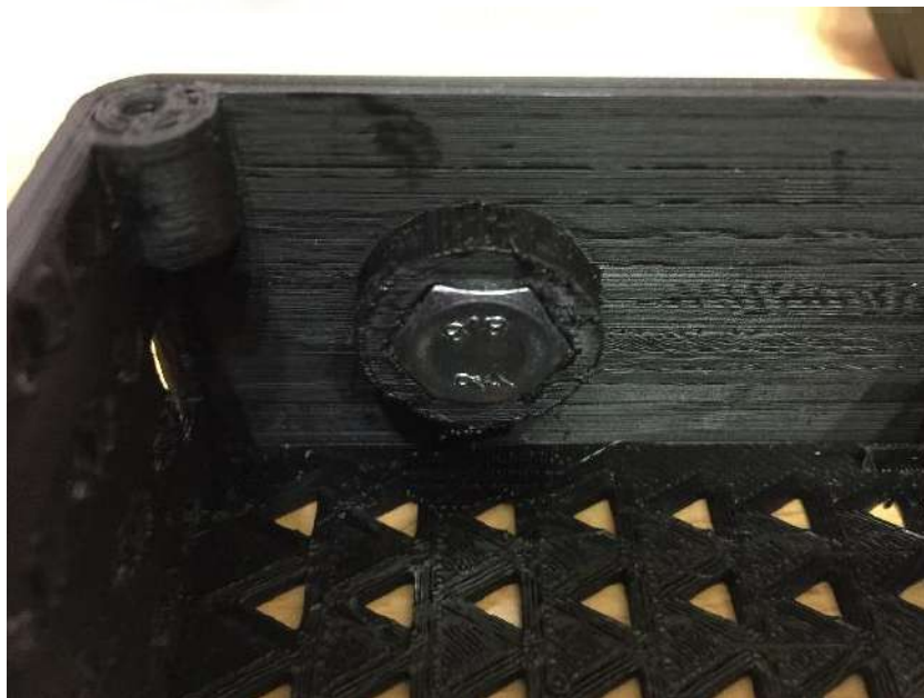
Figura 98 - Inserción del tornillo-eje de la caja de la muñeca
