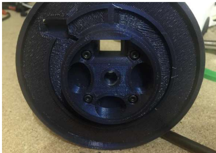
Figura 63 - Montaje de la rueda de la base del hombro
