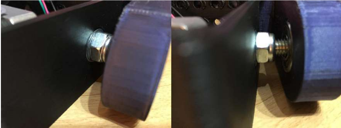
Figura 101 - Montaje del tornillo-eje de la muñeca
