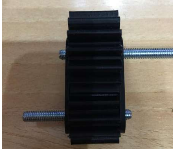
Figura 71 - Preparación de los ejes de los engranajes
