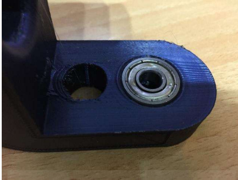
Figura 95 - Rodamiento de la muñeca insertado
