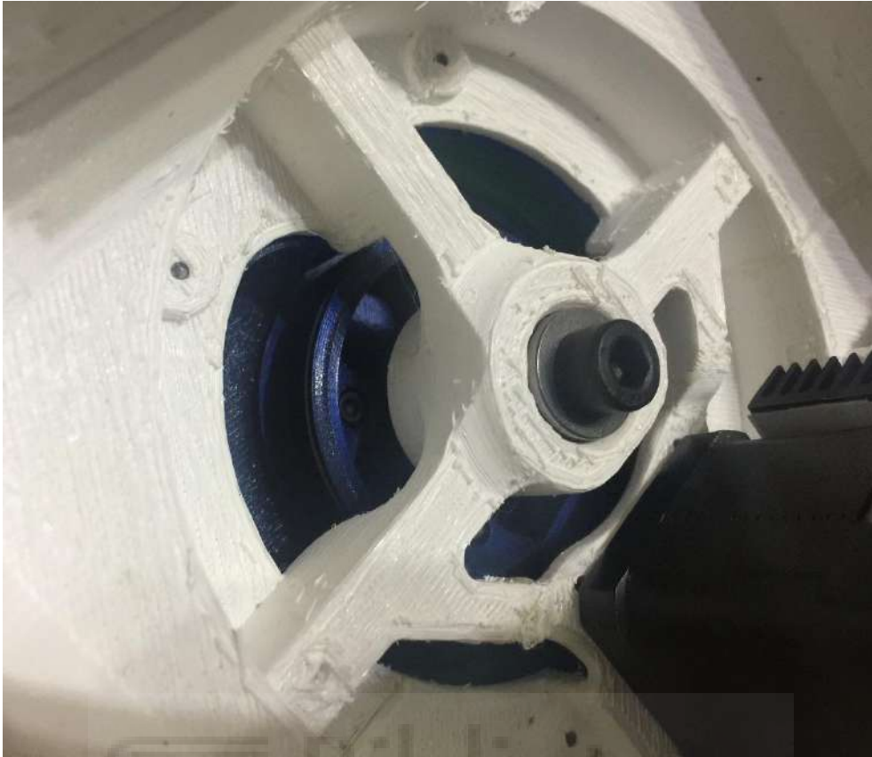
Figura 68 - Detalle de la correa de la base y el hombro
