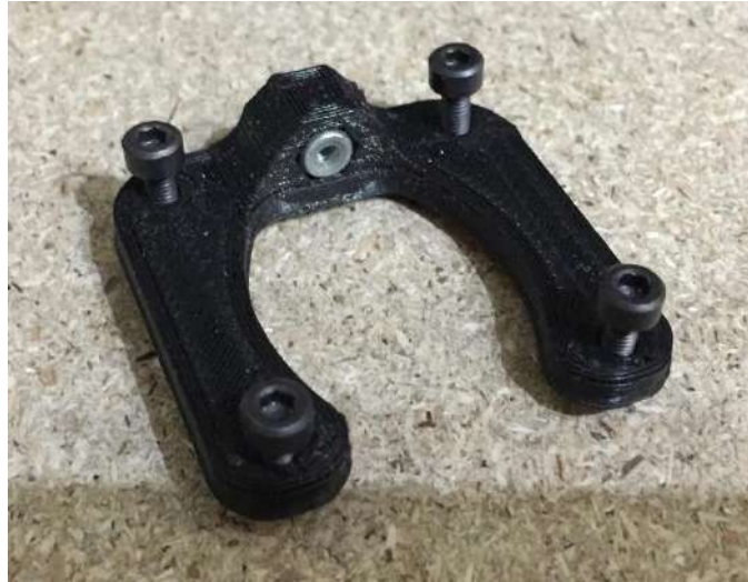
Figura 81 - Preparación del tensor de correa del codo
