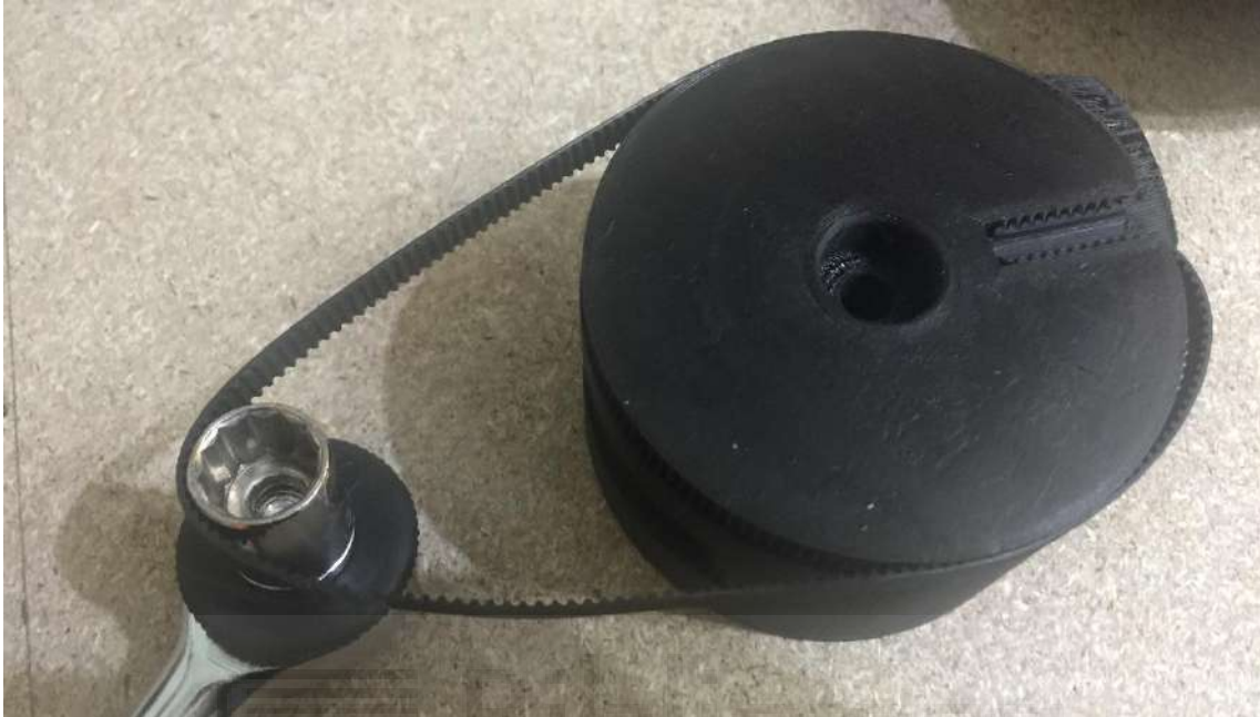
Figura 64 - Montaje de la correa del hombro
