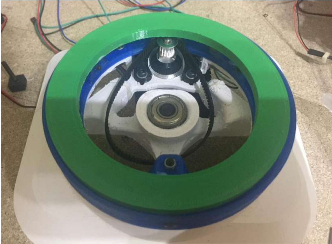
Figura 67 - Colocación de la correa dentada y el aro de rodamientos
