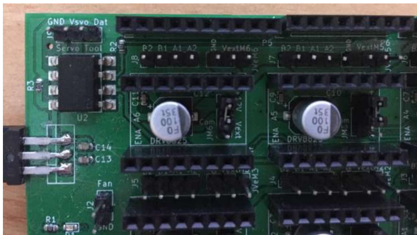
Figura 44 - Detalle del zócalo para conectar el driver DRV8825
