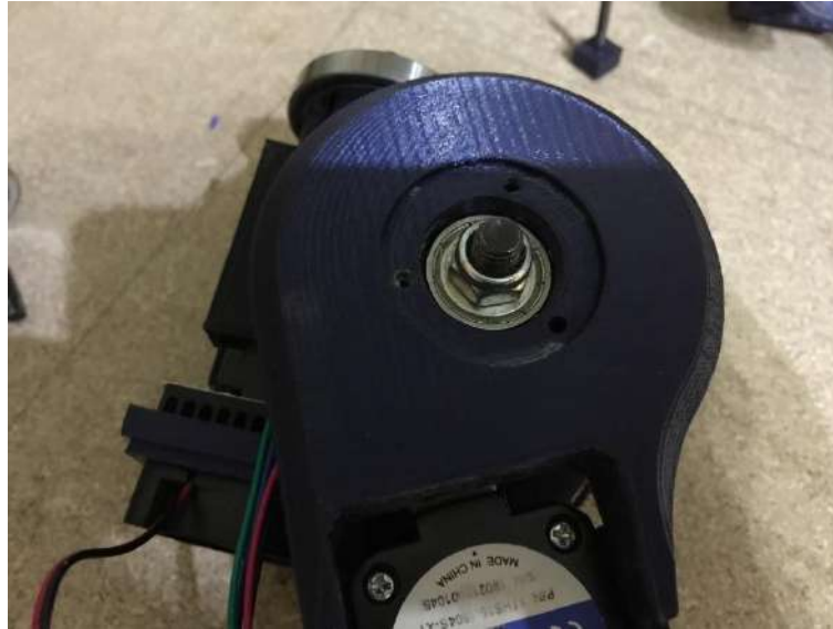
Figura 89 - Fijación de la articulación del codo
