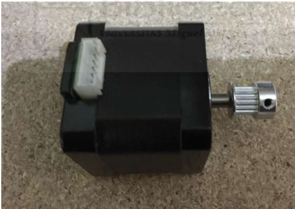
Figura 82 - Montaje del piñón de la articulación q3
