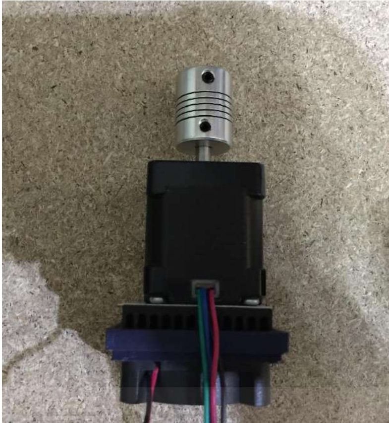
Figura 83 - Colocación del acople flexible en el motor q4
