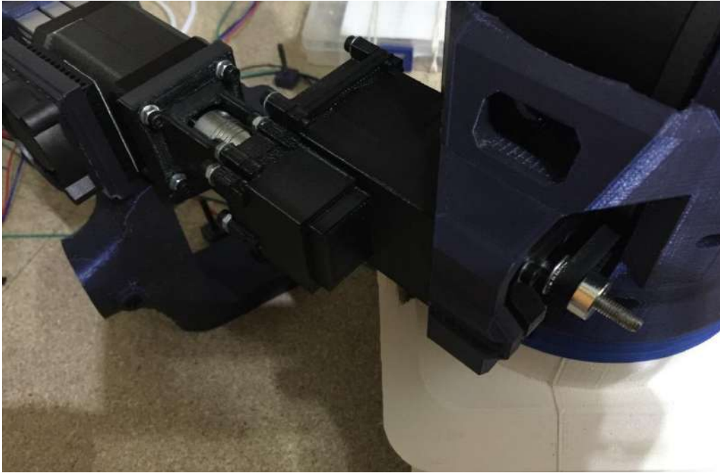
Figura 74 - Montaje de la caja reductora en el robot
