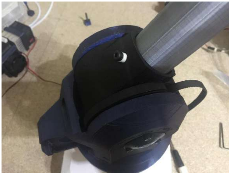
Figura 69 - Montaje final del hombro
