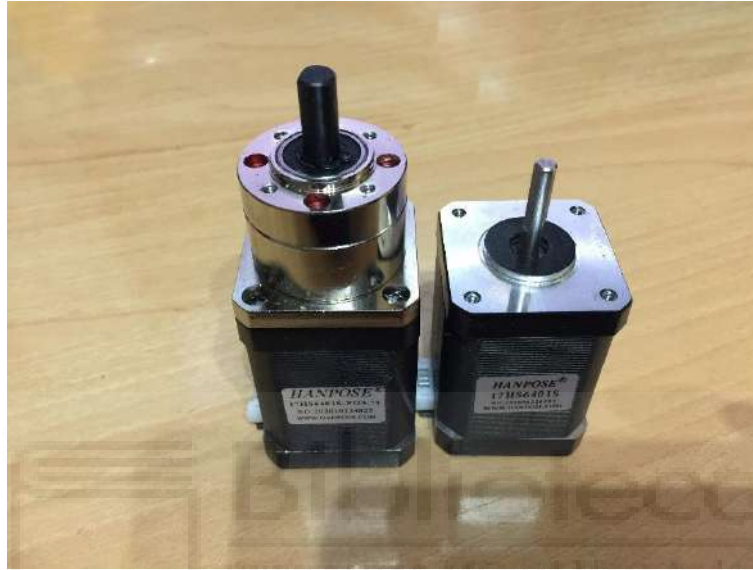
Figura 57 - Comparación del motor con y sin reductora
