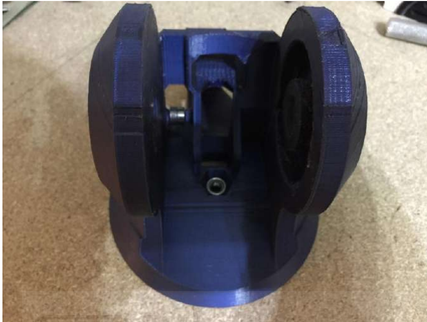
Figura 62 - Montaje de los rodamientos MR105 y tuerca M8 de la base del hombro
