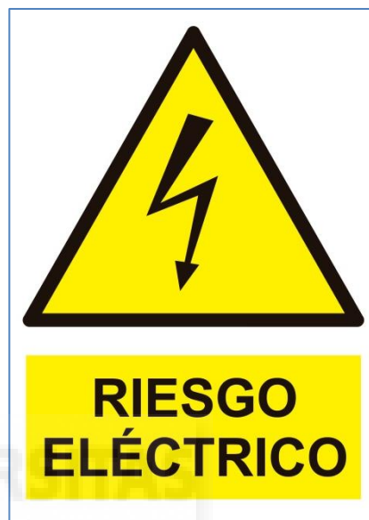
Figura 5. 19. Señal de riesgo eléctrico.
