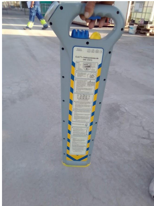
Ilustración 1 Detector de cables. Fuente: Elaboración propia.
