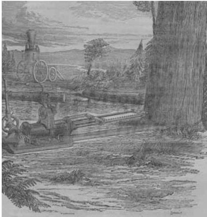
**Ilustración 1. Representación de la máquina de Ransome y, en segundo plano, motor a vapor. Fte. Revista Montes.**
