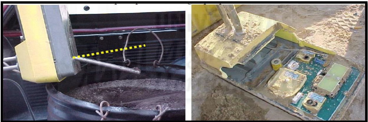
Figura 3. Equipos para medición de humedad y densidad dañados por descuido.
