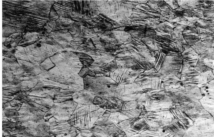
Figura 4. Microestructura de acero inoxidable austénico. Tomada de 29.
