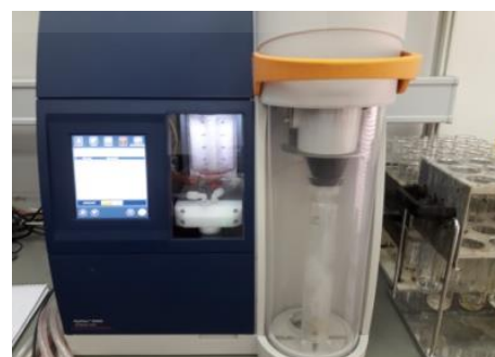
Figura 15. Destilador BüchiDestillationUnit modelo B-316.
