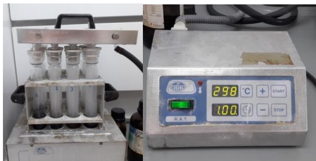
Figura 14. Digestor BüchiDigestionUnit modelo 426.
