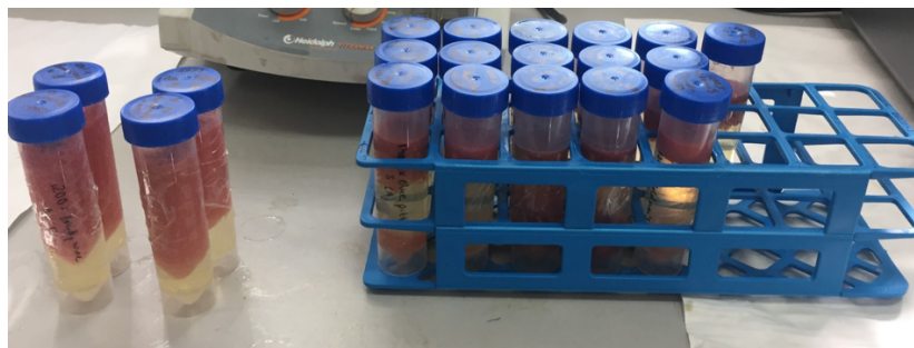
Figura 42: Muestras listas tras ser centrifugadas a 3500rpm durante 1 minuto.
