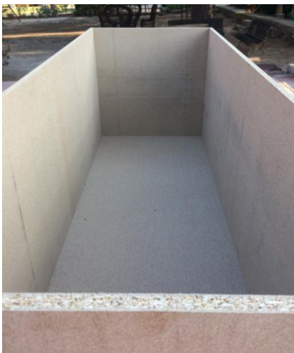
Figura 4. Cajón de madera montado. 200 x 70cm.
