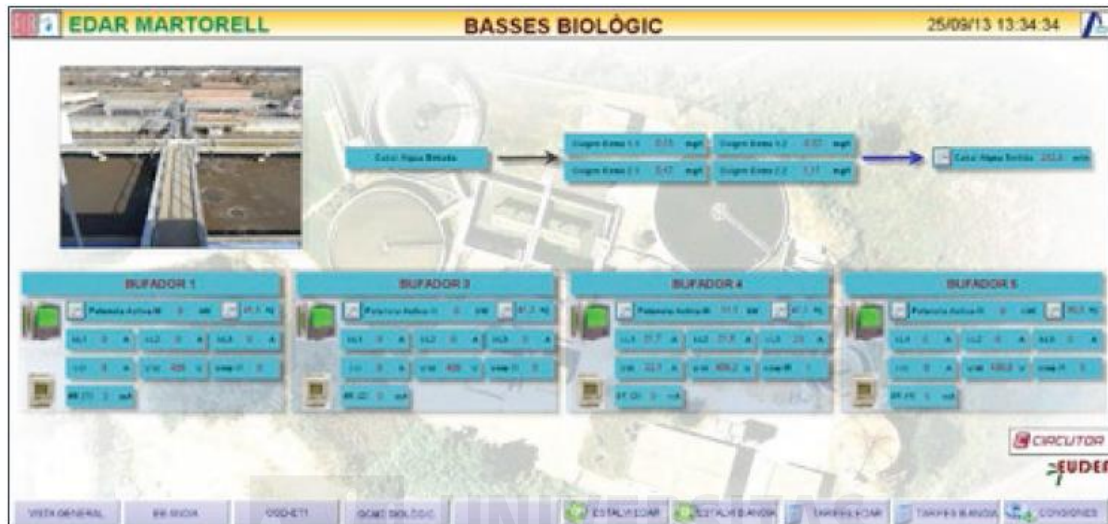
Figura 29. Vista general del software de adquisición, supervisión y control de energía en la EDAR de Martorell (Barcelona) (ACA, 2013).
