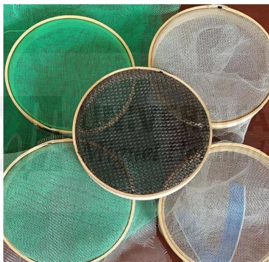
**Figura 1.** Tamices utilizados para prueba de Granulometría
