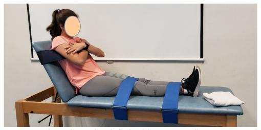
Figura 3. Test isométrico máximo de flexión del tronco contra dinamómetro manual.
