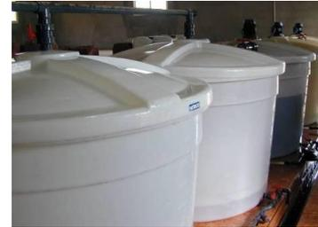
Los tanques, válvulas y accesorios para el llenado y el vaciado de los mismos se realizarán en PVC de Ø 50 mm. se conectarán al equipo de fertirrigación con tubería flexible de Ø 25 mm.
