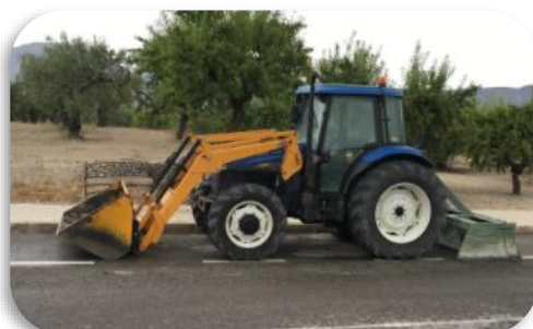
Tractor con pala empleado para montar la pila, realizar los volteos y transportar la cuba de agua.
