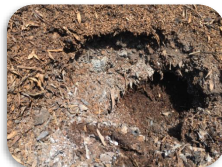
Corte vertical en el centro de la pila para tomar muestra representativa
