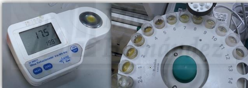
Figura 10. Refractómetro digital (imagen izquierda) y titrador o valorador de acidez (imagen derecha).
