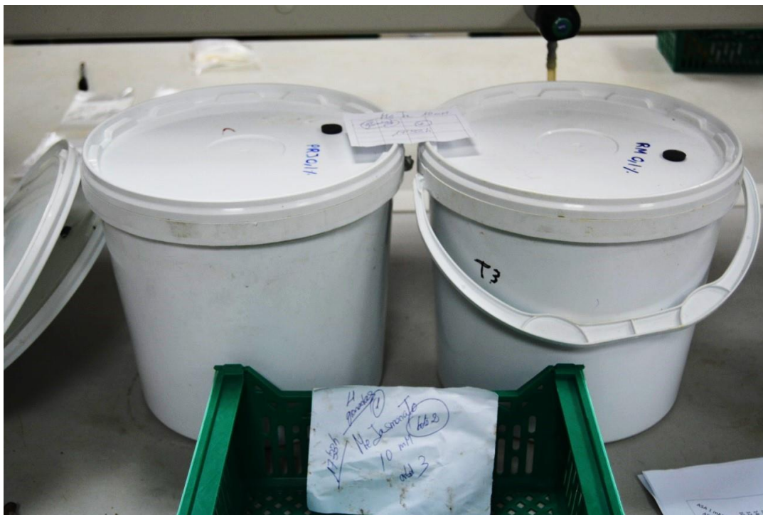
Figura 5. Sistema estático de botes de cierre hermético para la determinación de la producción de etileno y de la tasa de respiración de las granadas muestreadas.
