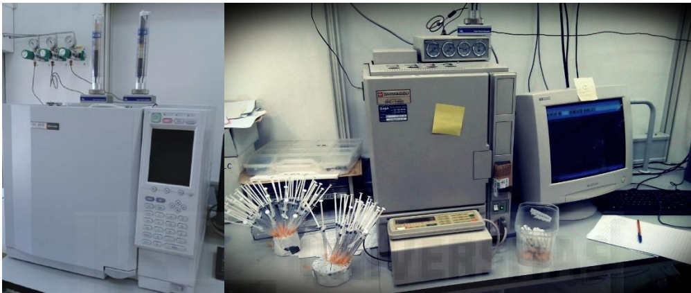
Figura 6. Cromatógrafos gaseosos descritos para la determinación de la producción de etileno (imagen izquierda) y la tasa de respiración (imagen derecha) de las granadas.
