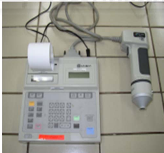
Fotografía 7: Colorímetro utilizado para medir el color.
