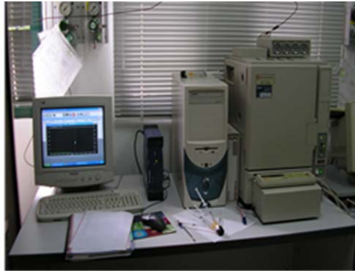
Fotografía 6: Cromatógrafo de gases utilizado para medir \text{CO}_2 y \text{O}_2 .
