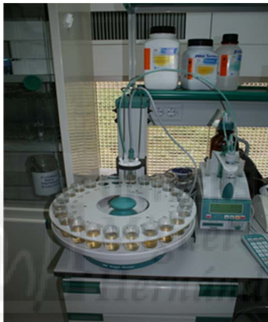
Fotografía 10: Valorador automático Methrom, utilizado para determinar la acidez.
